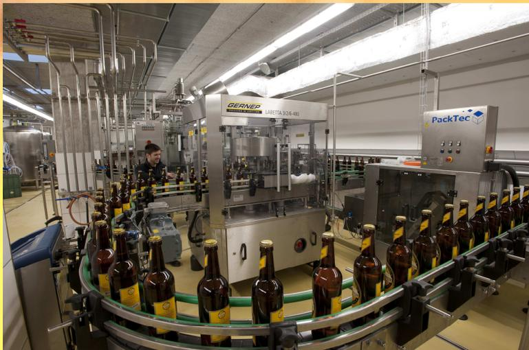
In unserer Flaschenabfüllung im ehemaligen Kulturgüterschutzraum reinigen wir unsere 5dl-Mehrwegflaschen nach dem maschinellen Auspacken zuerst in der Flaschenwaschmaschine gründlichst. Anschliessend werden sie im Leerflascheninspektor auf Beschädigungen geprüft und
